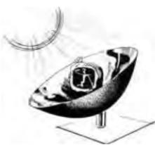
da la olla. Las cocinas con espejos concentradores de foco lineal o puntual utilizan la radiación directa, pero no aprovechan la radiación difusa. Las cocinas sin concentración son sencillas y están formadas por un cajón convenientemente aislado por el fondo y los lados, para que no pierdan el calor, y con una cubierta transparente compuesta por dos láminas de vidrio separadas entre sí. Su costo es muy variable y depende de los materiales usados y de su configuración.
